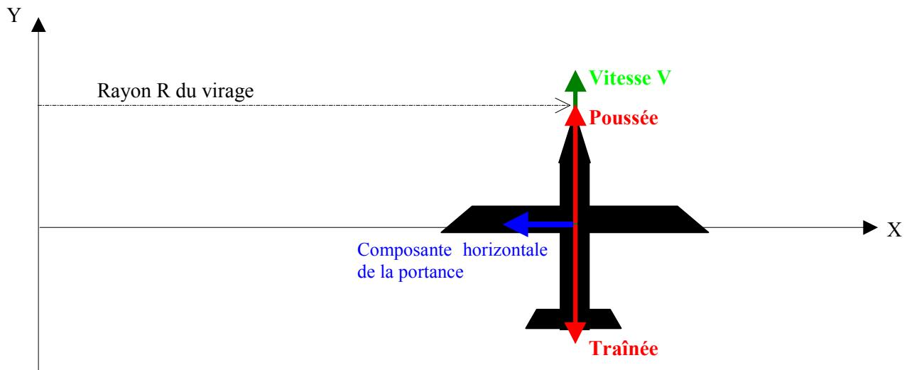
La composante verticale de la portance  $P$  est  $P.\cos\theta$ , elle équilibre le poids  $M.g$  : l'avion reste à altitude constante, donc  $P.\cos\theta = M.g$  ; la masse et la vitesse de l'avion étant supposées constantes pendant le virage, la portance de l'avion est donc constante et l'inclinaison est constante.
