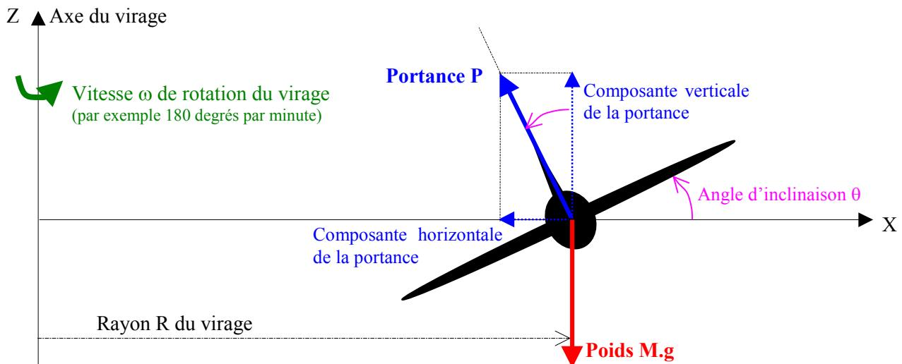
Dans le plan horizontal, la poussée équilibre à tout instant la traînée, la vitesse  $V$  de l'avion est constante et la seule force résultante est la composante horizontale de la portance :
